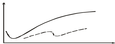
Obr. 9: Paschenové krivky platné pre homogénne elektrické pole (a) a pre nehomogénne pole (b)
