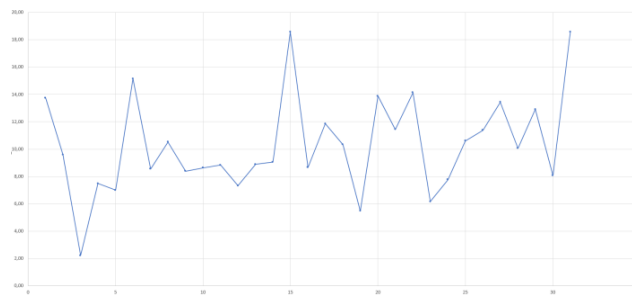
Obr. 4. Priebeh nabíjania AC záťaži počas vybraného mesiaca (x-ová os dni v mesiaci; y-ová os odoberaný stredný výkon v kW)
