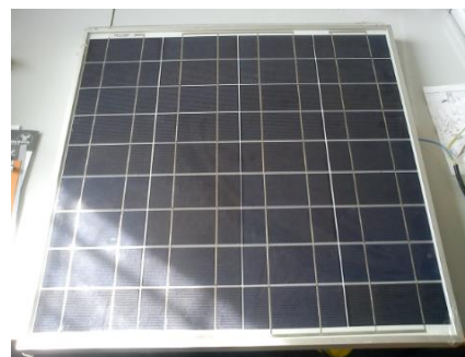
Obr. 2. Fotovoltaický kolektor SY-55P použitý pri meraní
