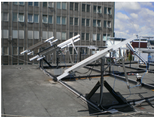
Obr. 4. Inštalácia fotovoltaických panelov pomocou polohovacieho zariadenia - trackera.
