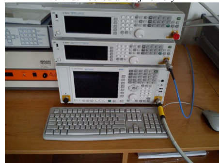
Obr. 3. Pracovisko pre účely merania účinnosti tienenia - pohľad na pracovisko mimo bezodrazovej komory
