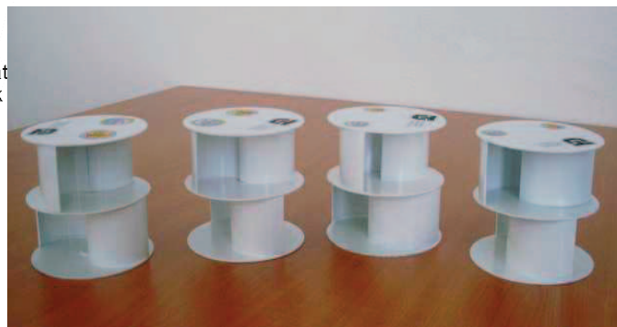
Obr. 5 Dvojstupňové rotory s presahom lopatiek 0-10-20-30mm
