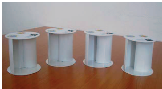
Obr. 4 Savoniusové rotory s presahom lopatiek 0-1-2-3 cm
