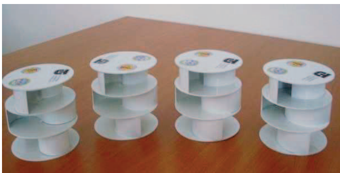
Obr. 6. Trojstupňové rotory s presahom lopatiek 0-10-20-30 mm
