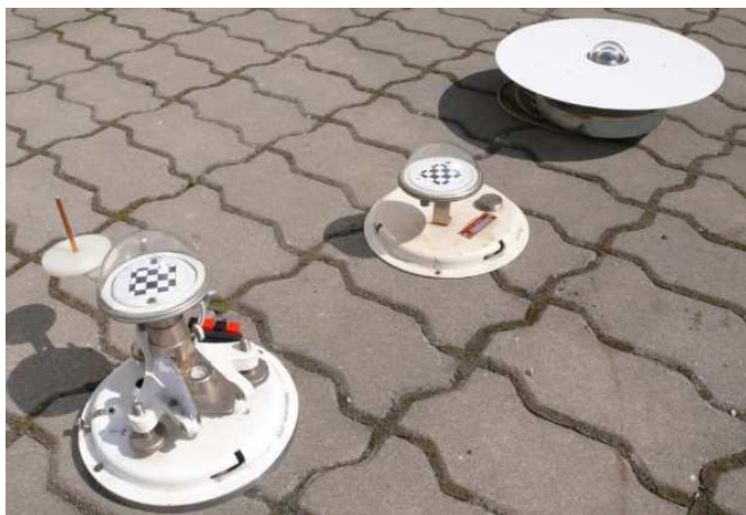
Obr. 7 Pyranometre používané v LNZE
