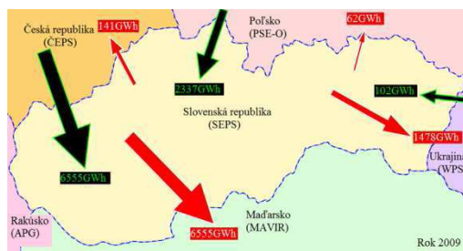
Obr. 1. Namerané cezhraničné prenosy elektriny v GWh za rok 2009.
