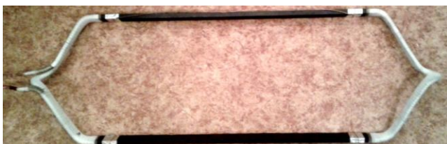
Obr. 4 Skúmaná cievka s polovodivým náterom [9]
