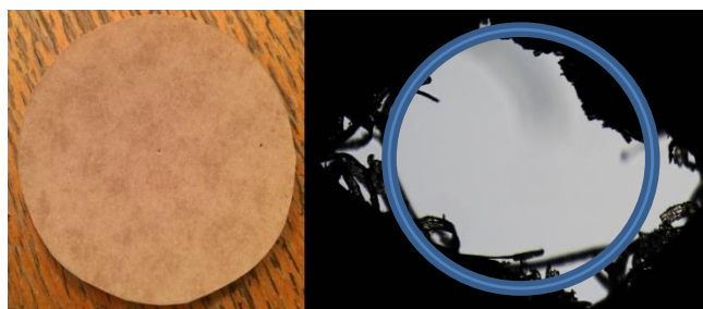
Obr. 1. Vzorka TP \varnothing=60 mm (vľavo) a mikroskopický detail umelej dutiny a jej efektívny priemer \varnothing=1,25 mm vyznačený modrou kružnicou (vpravo).
