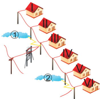
Obr. 4. Model časti nn siete (odberné miesto) použitý v programe ATP.
