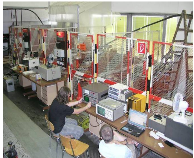
Obr. 1 Pracovný priestor pri meraní napäťovej závislosti fázového rozloženia zdanlivého náboja ČV
