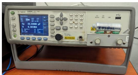
Obr. 2. RLC meter Agilent E4980A s vloženou meranou vzorkou.
