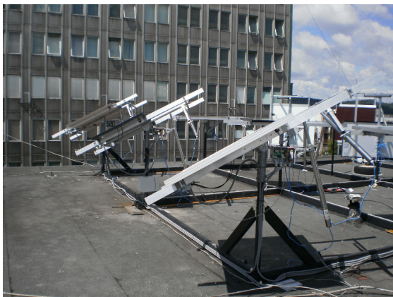
Obr. 4. Fotovoltaické panely v externej časti laboratória (pohľad na FV panely umiestnené na trackeroch; popis je uvedený v prvom stĺpci tabuľky I.)
