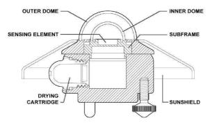
Fig. 1 Pyranometer Kipp&Zonen CMP 6 [3]
