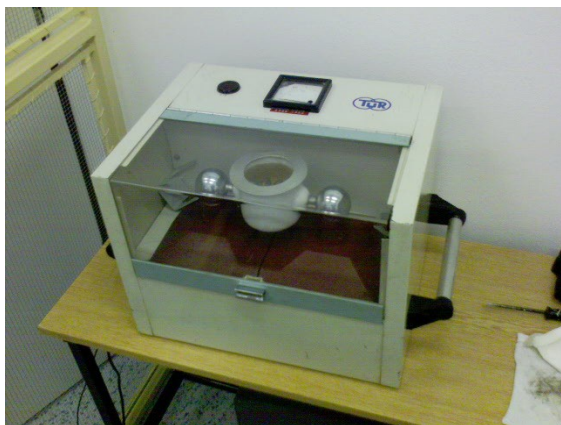
Obr. 2 Prístroj TUR na meranie preskokového napätia
