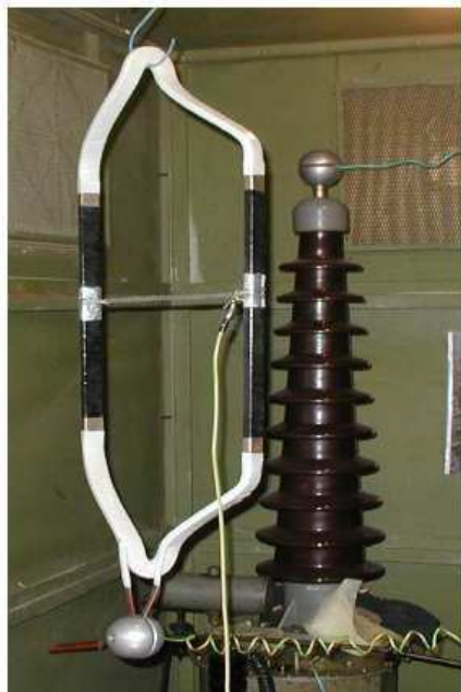
Obr. 2 Umiestnenie skúšanej cievky pri meraní častkových výbojov
