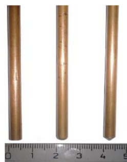
Obr.6 Hrotové elektródy pre modelovanie korónových výbojov
