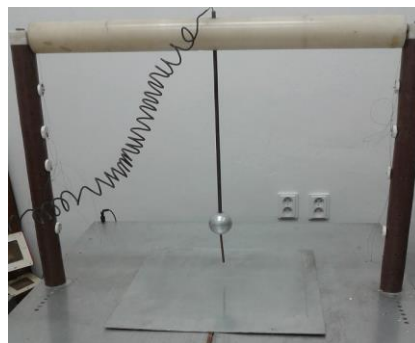
Obr. 5 Elektródový systém hrot – doska [8]
